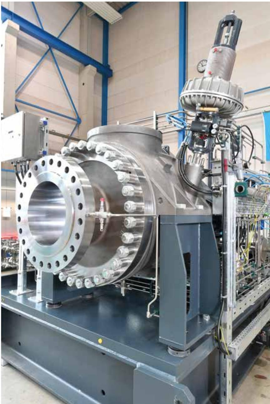
Expansions-turbine für eine Erdgasanwendung.
