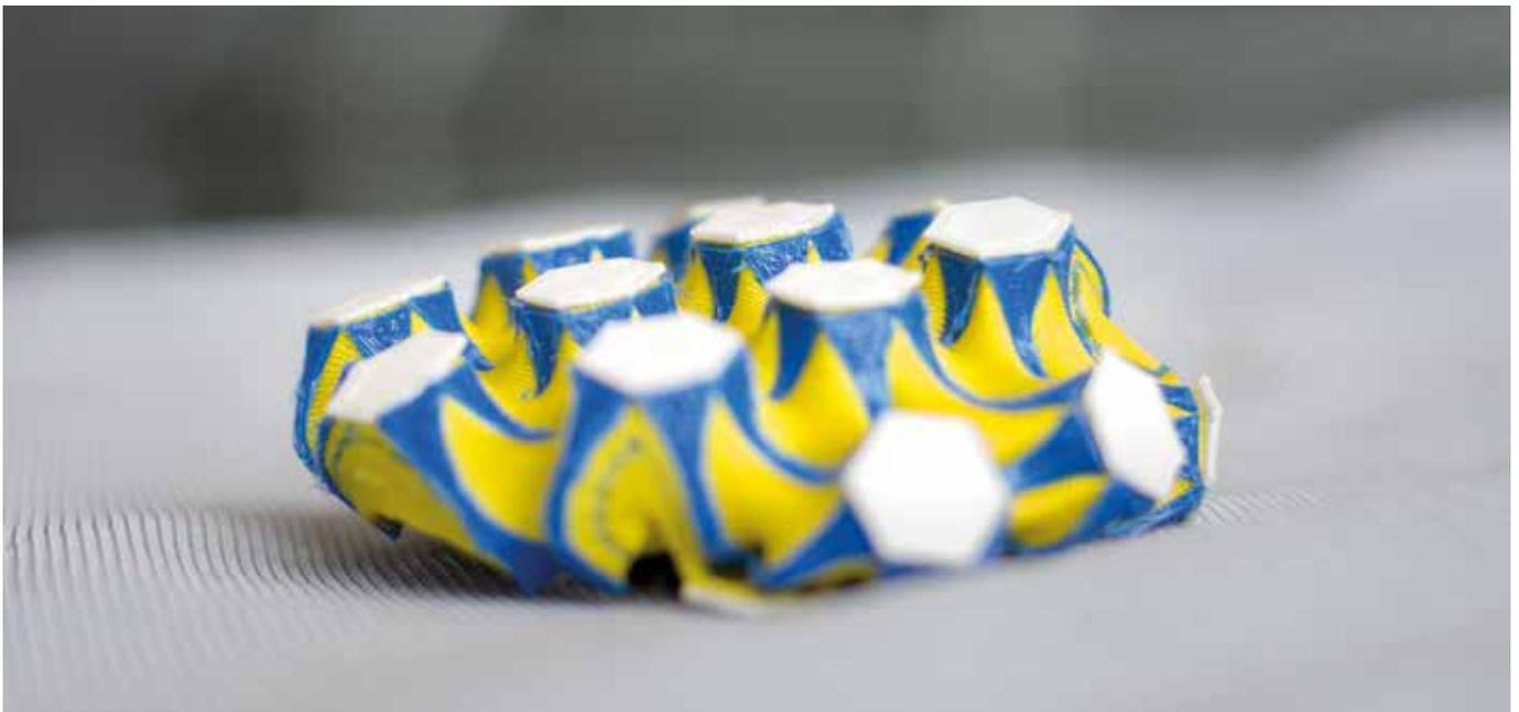
Morphende 4D-Textilien mit Taster-Oberfläche für die Mensch-Maschine-Interaktion.
