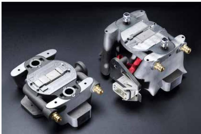
Durch das „Direct Tooling“ ist die Herstellung umformender Werkzeuge und konturnah gekühlter Werkzeugeinsätze mit gesteigerter Performance und im Leichtbaudesign möglich.
