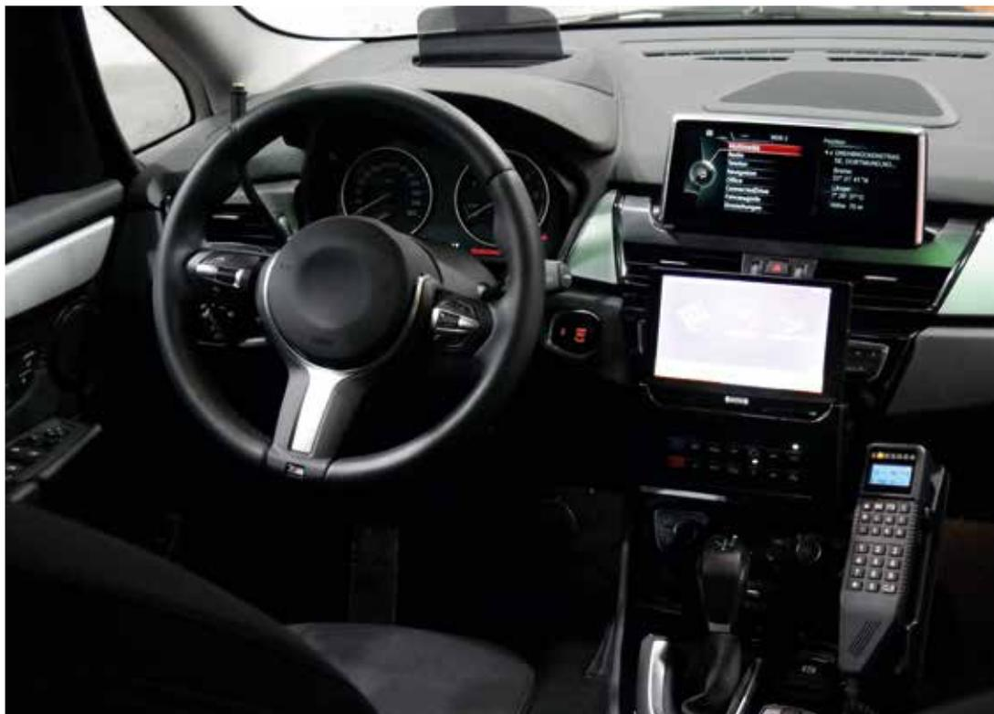
Die neue Halterung wird probeweise installiert, um das Notarzteinsatzfahrzeug mit Funk- und Kommunikationstechnik nachzurüsten.
