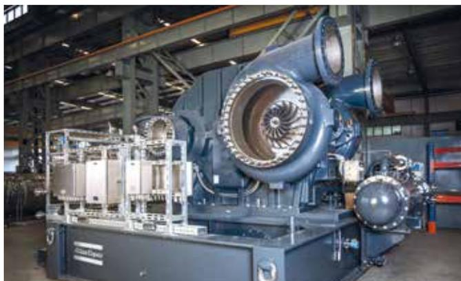
Getriebeturboverdichter von Atlas Copco Energas.
