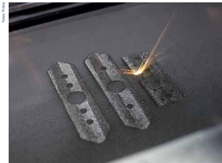
Neue Materialien wie Kupfer, Messing, Zink und neue Werkzeugstähle für das Direct Tooling von high-performance Werkzeugen und das Direct Manufacturing von Endprodukten.
