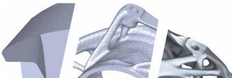
Schrittweiser Übergang von einem massiven Grundkörper zu einer optimalen Leichtbaustruktur eines Radträgers.
