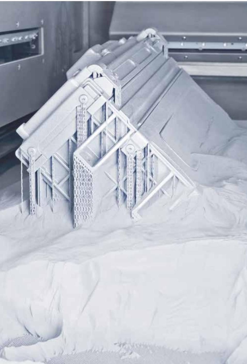
„Wir benötigen Metallkomponenten in moderaten Stückzahlen, mit hoher Funktionsintegration, optimalen mechanischen und thermischen Eigenschaften sowie einer strömungsoptimierten Gasführung.“ – Mit diesem Wunsch kam ein Hersteller von Gasturbinen auf die Solidteq GmbH aus Neuss, 3D-Druck in Metall, zu. Konkret angefragt wurden beispielsweise das Verdichter- und das Impellergehäuse für eine kleine, kompakte Gasturbine mit einem Leistungsspektrum von einigen hundert Kilowatt.
